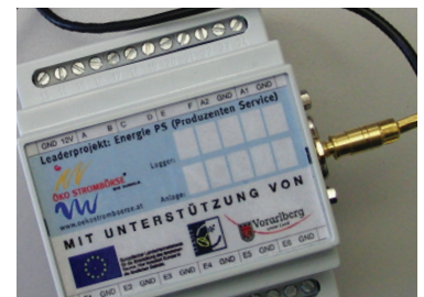
Datenlogger (Einbau im Zählerkasten)
